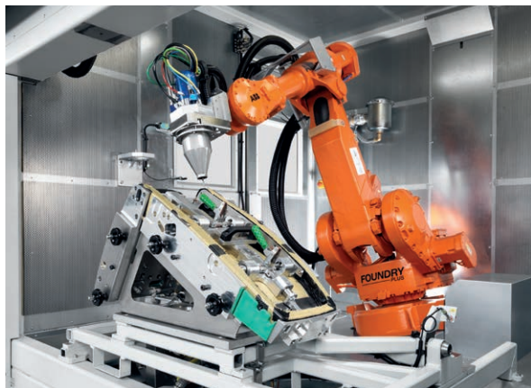
直升机座椅的机械手铣削设备
