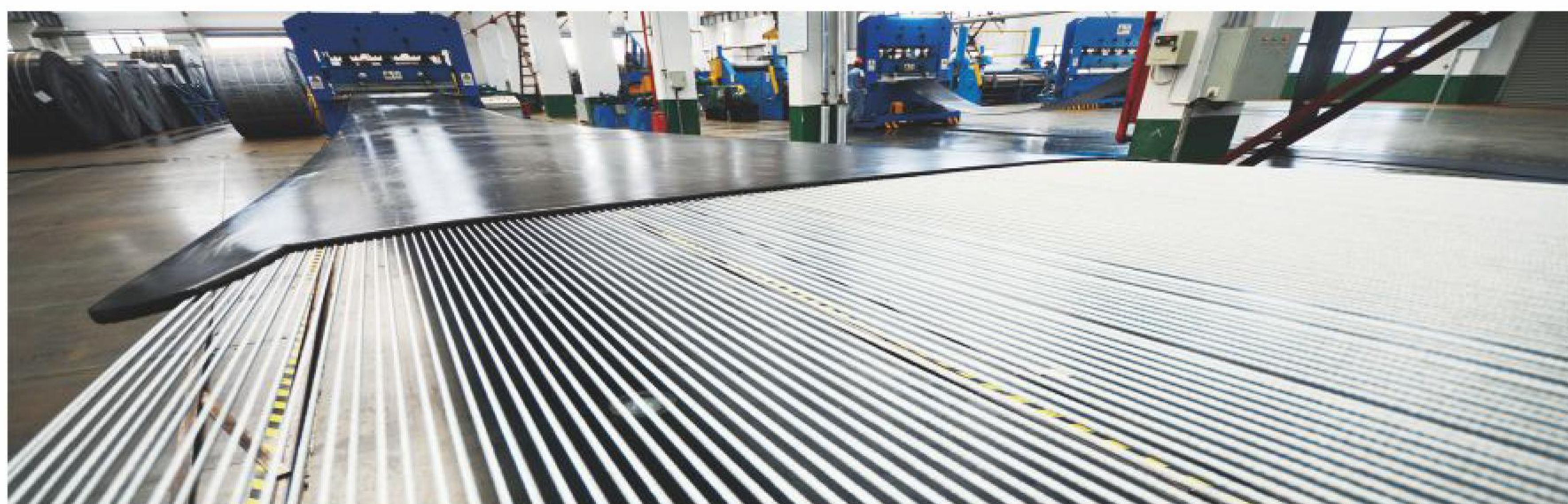
DLB-G (N) 3200×16000平板硫化机组 3200×16000 multi-unit press
